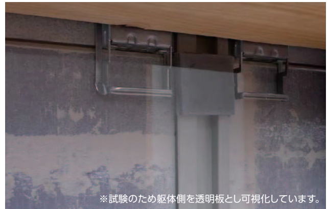
サイディング裏面の幅広目地ジョイナーの室内側は濡れていません。
