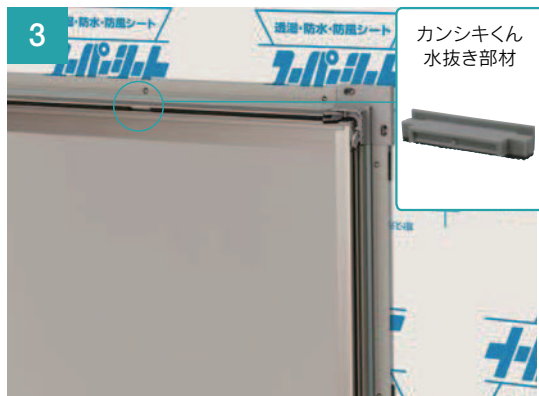
開口部上に「カンシキくん目地ジョイナー」を留め付ける場合は、あらかじめ開口部上に留め付ける「カンシキくんアルミベースN」に、切り欠き加工を施して「カンシキくん水抜き部材」を差し込みます。「カンシキくん水抜き部材」は「カンシキくん目地ジョイナー」直下及び910mmピッチ毎に取り付けます。
